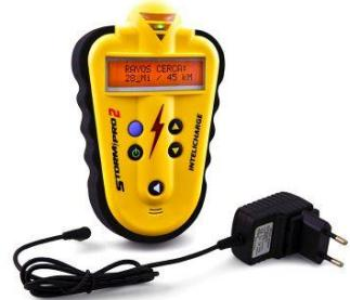
**Procedimiento para la recalibración:** Correr el Test de ruido o "Noise Test" (como se describe en el manual del Storm Pro) dos veces consecutivas en una ubicación tranquila (sin interferencia electromagnética) y, preferentemente, al aire libre. Es importante destacar que no deben haber tormentas en un radio de 50 millas (75 km).
